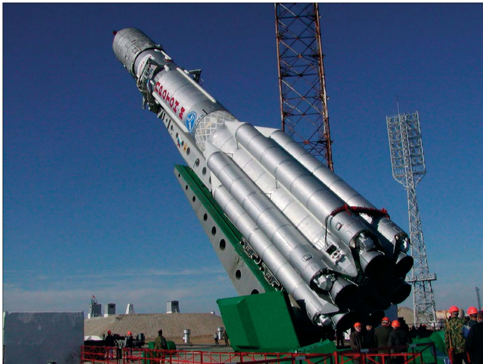
“Proton-M/Briz-M” ar pavadoni “AMC-15” tiek uzstādīts startam, kas notika 2004. gada 15. oktobrī. Nesēja izmaksu samazināšanas dēļ ražote netiek krāsota. ILS attēls
