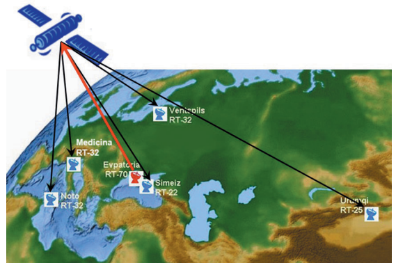
4. att. Kosmisko atkritumu novērojumu shēma. Signālu raidošā antena Ukrainā Eipatoria (RT-70). Signālu uztverošās stacijas: Latvijā Ventspils (RT-32), Ķīnā Urumqi (RT-25), Itālijā Medicina (RT-32), Itālijā Noto (RT-32), Ukrainā Simeiz (RT-22).
