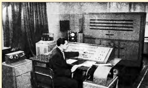
4. att. Inženieris A. Oļeiņiks pie LM-3 vadības pults testē izvada ierīces darbību. Attēlā redzama arī ievades ierīce (pa kreisi), atmiņas mezgls un datora galvenais skapis (pa labi).
