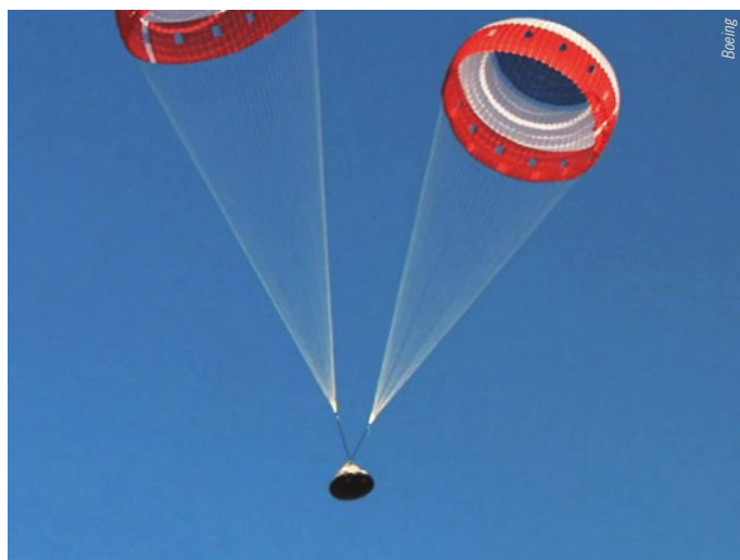
Boeing CST-100 Starliner kapsula nolaižas ar diviem no trim izpletņiem
