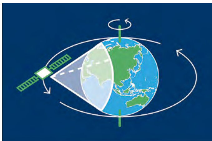
1. attēls. Ģeostacionārais satelīts orbītā virs Zemes ekvatora “pārskata” lielu daļu Zemes virsmas
