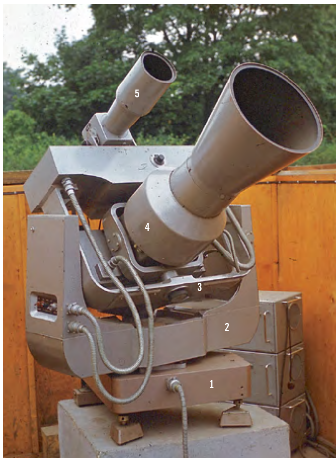
Fotokameras AFU-75 kopskats. 1 – ekvatoriālā platforma, 2 – montējuma dakša, 3 – horizontālās ass pusrāmis, 4 – kameras objektīvs, 5 – teleskops-gids
